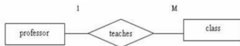
ภาพที่ 2.2 ความสัมพันธ์แบบ หนึ่ง-ต่อ-กลุ่ม
